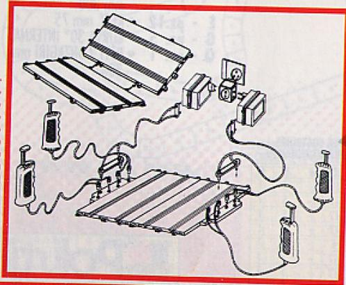
Per costruire una pista a 4 corsie saranno necessari due rettilinei presa corrente (uno ogni due macchine) - due trasformatori 12 volt - quattro pulsanti e un numero sufficiente di rettilinei e curve da 30° e 60° a seconda del circuito.
