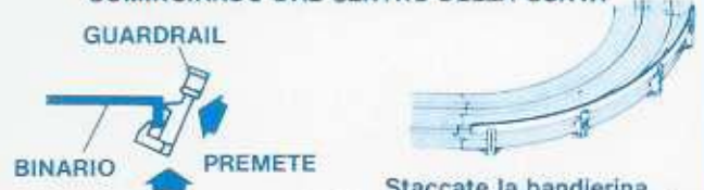
Fig. 6 INSERITE IL GUARDRAIL COMINCIANDO DAL CENTRO DELLA CURVA
